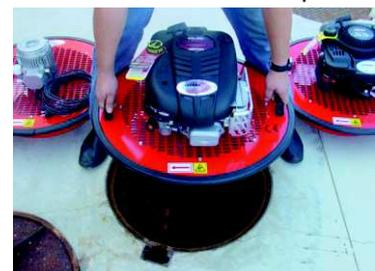
*Antes de utilizar cualquiera de nuestros equipos de ventilación, ha de comprobarse que no hay presencia de gases explosivos en el subsuelo donde va a utilizarse nuestro equipo. Si existieran gases explosivos, utilizar primero la Serie CVG - Antichispa.*
